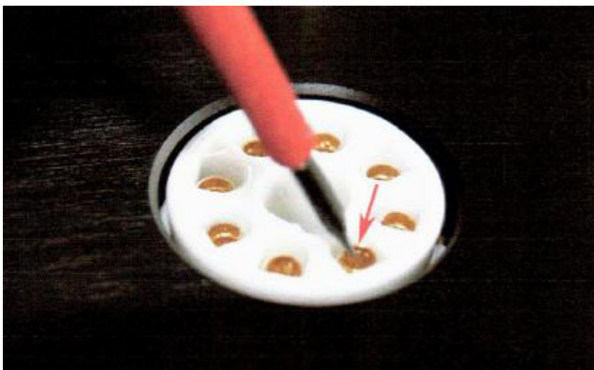
Рис. 5. Внешний контакт немного загнут внутрь – внутренняя пружина дополнительно загибается
