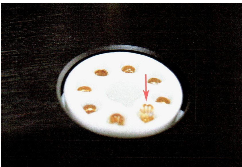
Рис. 2. Внутренняя пружина (частично вынута)
